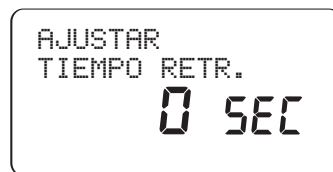
Ilustración 22: Pantalla – Aplazamiento en estación
